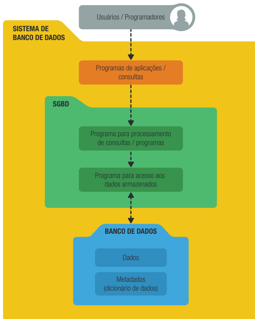
Figura 10 – Diagrama simplificado da arquitetura de um Sistema de Banco de Dados (Adaptado de SANCHES, 2005)
