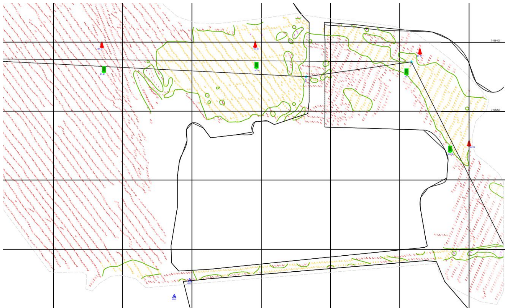
Figura 10A: Batimetria do Canal de Itajurú (2008). Porção mais a Oeste no limite da laguna. Profundidades de 0,00 a 1,99 m (1,3); profundidades de 2,00 a 2,99 m (2,3); Profundidade de 3,00 a 3,99 m (3,3). Considerando que a embarcação utilizada não fez medições mais rasas do que 1,00 m, toda a área vermelha compreende profundidades entre 1,00 e 2,00 metros. A linha verde delimita as isóbatas.
