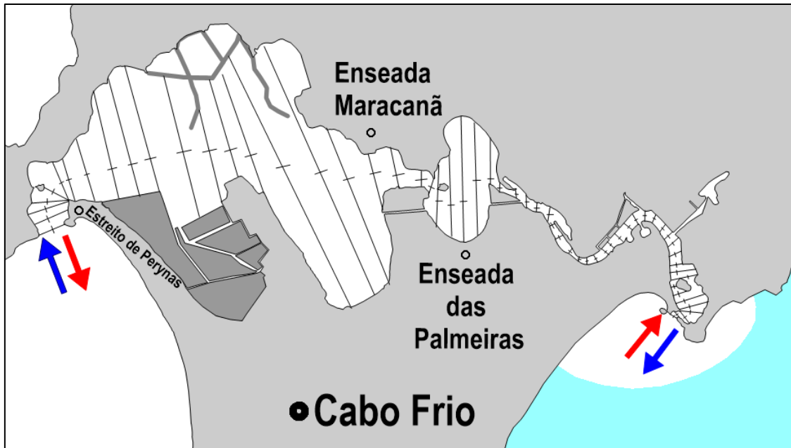
Figura 60 - Seção de cálculo determinada para obtenção das vazões de entrada e saída do sistema.
