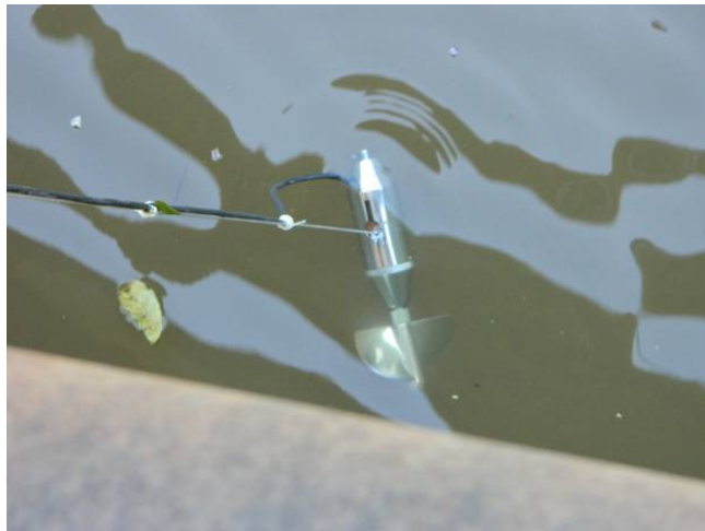
Figura 9: Molinete mergulhado nas águas do Rio Capivari, fazendo as medições de vazão
