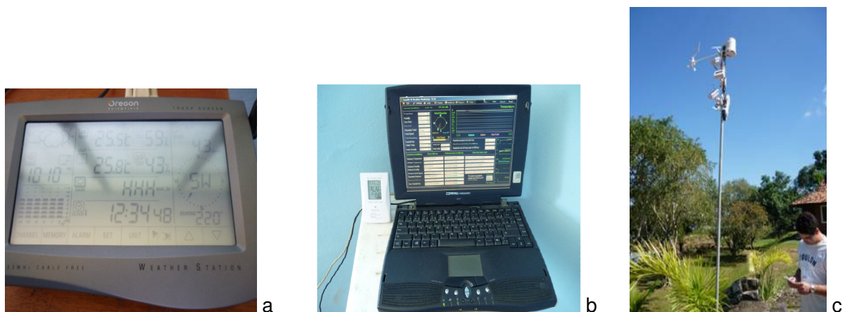
Figura 13: Estação meteorológica instalada em frente à casa de operações da represa de Juturnaíba. a) receptor dos dados obtidos nos sensores (via rádio); b) computador que grava os dados obtidos; c) sensores de medição dos parâmetros meteorológicos.
