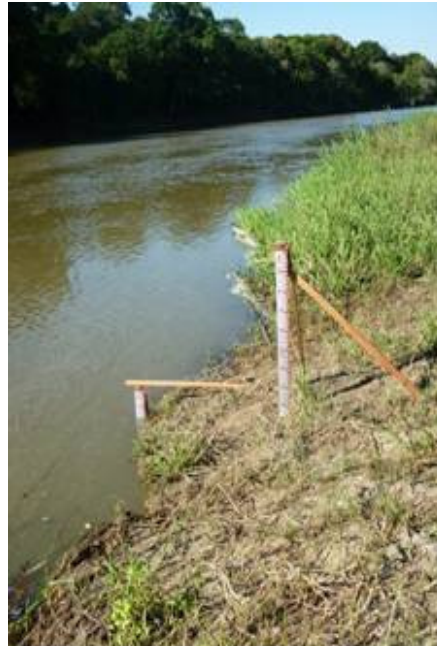
Figura 11: Réguas instaladas no baixo São João, próximas ao vertedouro da represa de Juturnaíba.
