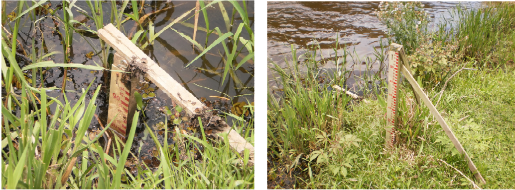
Figura 4: Leitura de réguas de vazão instaladas as margens do Baixo São João realizada no campo de dezembro de 2011 (estação 7).
