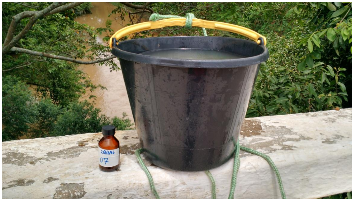
Figura 03: Detalhe do frasco e balde utilizado na coleta de água do ponto 07 (Capivari - Pórtico de Silva Jardim)
